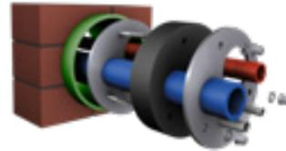
Verhindert durch Quetschdichtung Wärme- und Feuchtigkeitsbrücken an Mauerdurchbrüchen. Durchführungsmöglichkeiten für Nachspeiserohr (nur bei DN160), Saugschlauch, Sensorkabel sowie Pumpen- bzw. Schwimmerschalterkabel.
