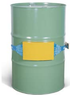
Bild 10: Beschädigtes Gebinde, bei dem die Transportfähigkeit durch eine Fassbandage wieder hergestellt ist
