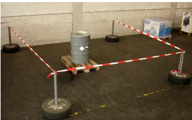
Bild 7: Absperrung des Gefahrenbereiches um ein beschädigtes Gebinde
